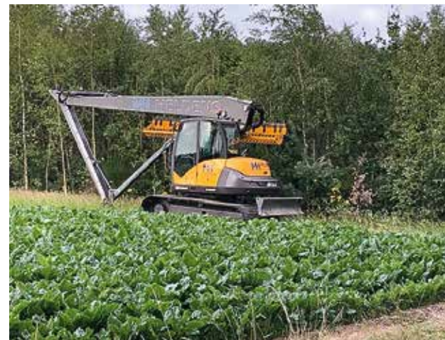
De giek met maaikorf in transportstand. Dankzij sterke wielmotoren haalt de Mecalac ook in mindere omstandigheden een rijnsnelheid van 10 km/u.
