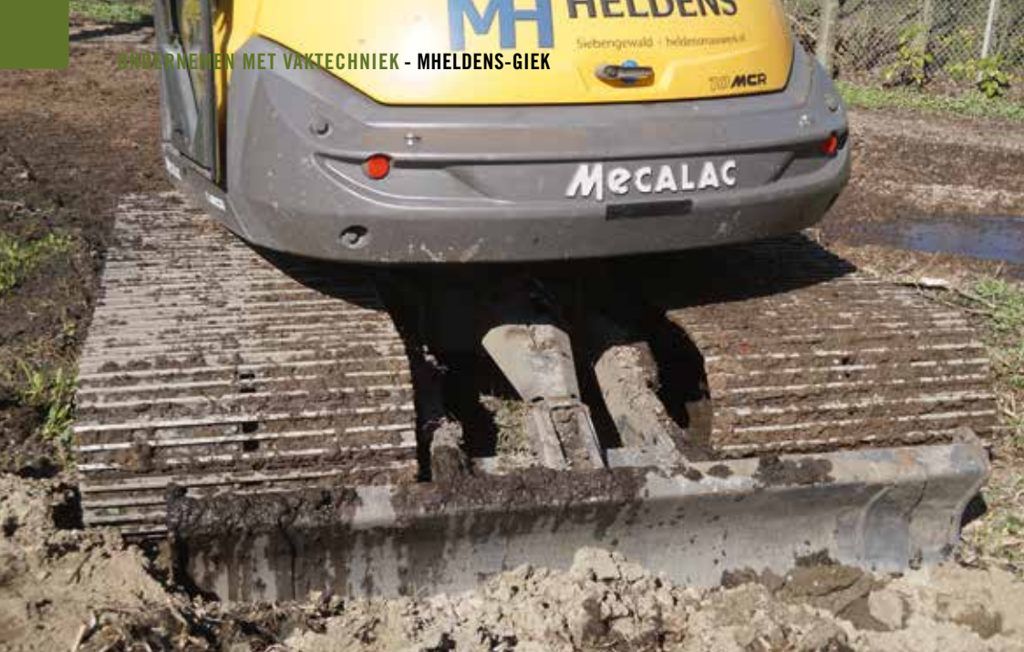
De Mecalac staat op één meter brede rupsen. Dit geeft een bodemdruk van circa 0,5 kilo per vierkante centimeter.
